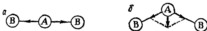
Рис. 30. Дипольные моменты отдельных связей в молекулах типа AB_2 различного строения: а — линейное строение; б — угловое строение; жирной средней стрелкой показан вектор суммарного дипольного момента молекулы.
