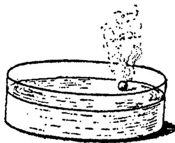
Рис. 56. Выделение водорода из воды натрием.
