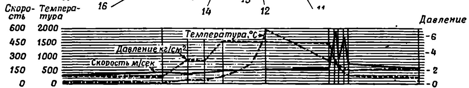
Ф и г. 8. Разрез двигателя „Дарт“ фирмы „Роллс Ройс“ и изменение физических параметров газов по его тракту.
