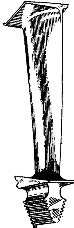
Фиг. 132. Рабочая лопатка турбины с елочным замком и полкой, сделанная из сплава «нимоник 95». («Роллс Ройс»).
