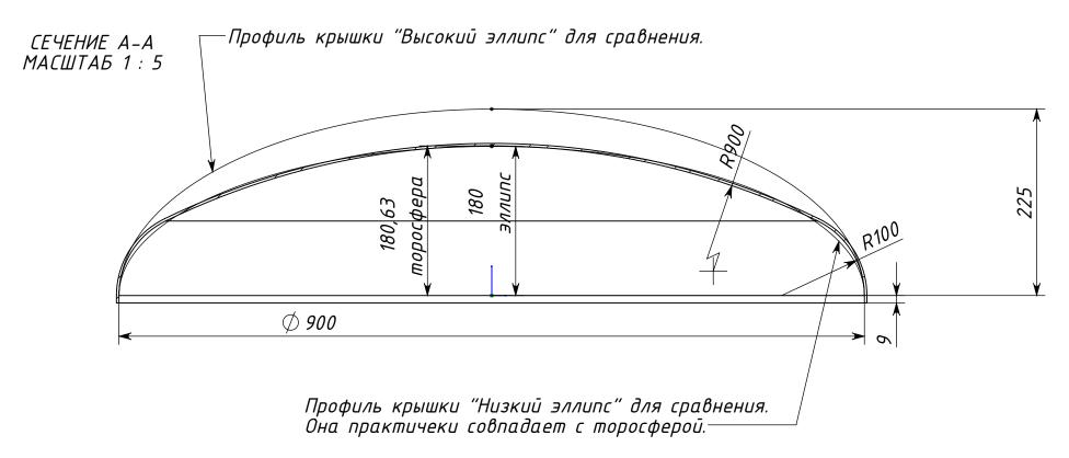
Диаметр заготовки исходя из равентсва объёмов 1050 мм, округлённо, берём с запасом 1100 мм.
