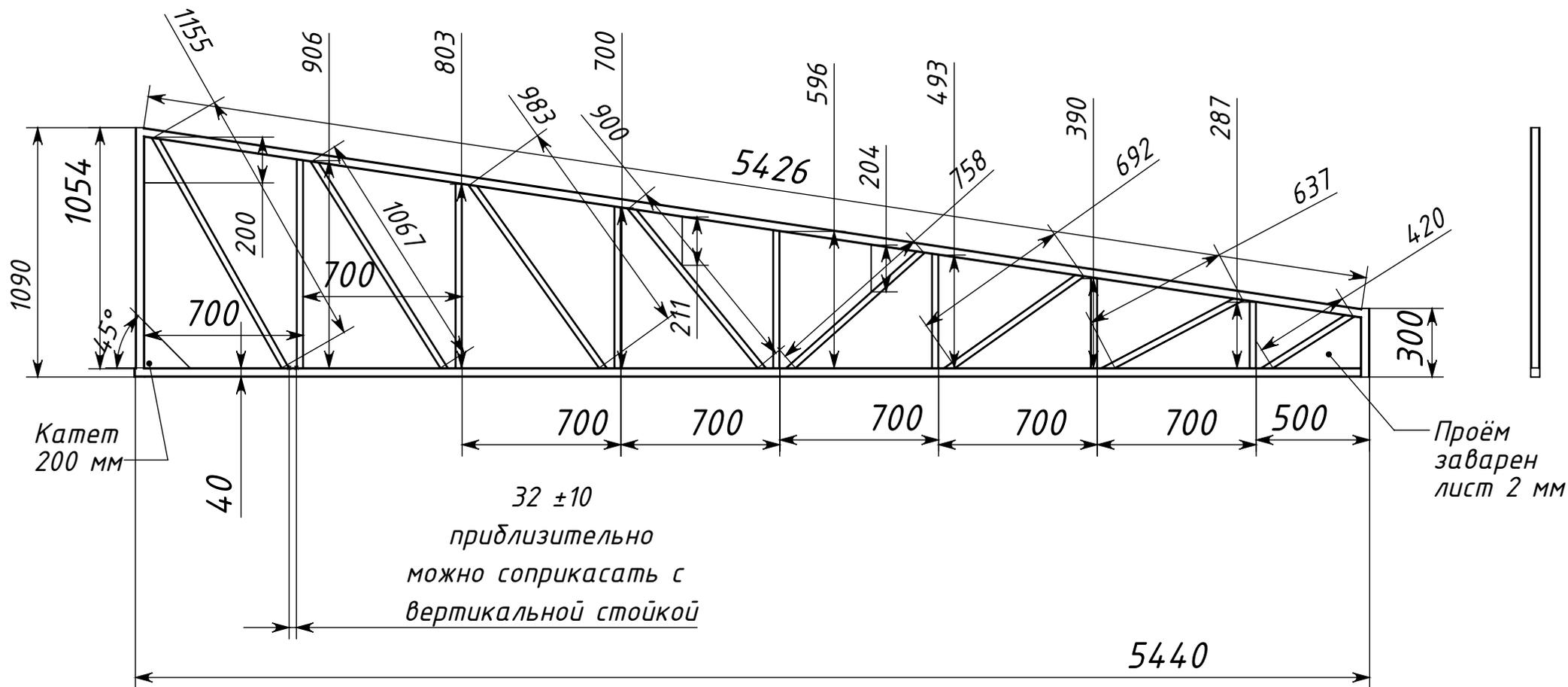
Периметр 40x40x3, остальное 30x30x2 мм профиль квадратный. Небольшие отклонения в размерах не принципиальны. Сделать один, остальные по образцу.
